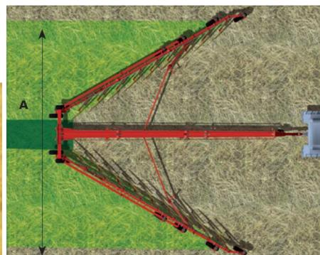
**3-6см Стерневой культиватор для сплошной обработки почвы, в т.ч. для неглубокой предпосевной обработки и механического гербицида**
